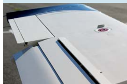
Des déflecteurs sur la voilure pour renforcer l'effet des gouvernes de direction étroites
