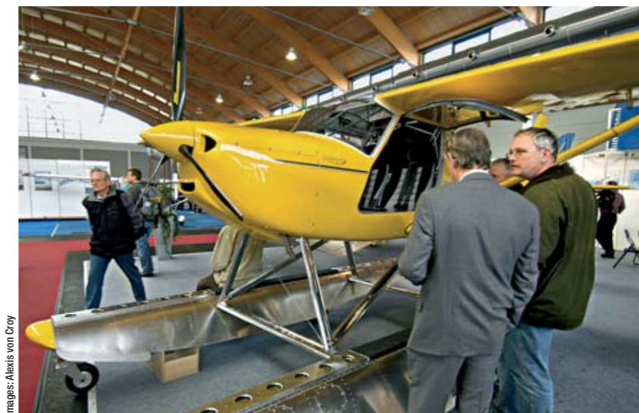
Ultraligero FK9, equipado con motor de Smart, un aparato extraordinariamente silencioso y respetuoso con el medio ambiente gracias a su catalizador.
